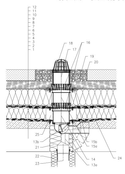
ZUM BEHEIZEN DES ABLAUFES KANN DAS BEGLEITHEIZUNGSSET HL82 MIT SELBSTREGULIERENDER WÄRMEQUELLE ZUM BEHEIZEN DES ABLAUFES KANN DAS BEGLEITHEIZUNGSSEI HILOZ MIT SELBSTREGULIERENDER WARMEQUELLE 18W/230V VERWENDET WERDEN. (DAS HEIZBAND WIRD VOR DEM VERLEGEN DES ABLAUFES UM DEN ABLAUFKÖRPER GEWICKELT)
