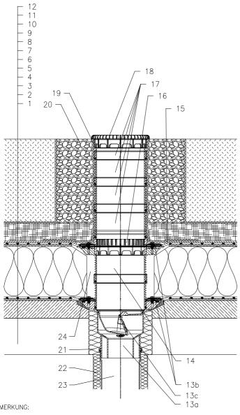
ZUM BEHEIZEN DES ABLAUFES KANN DAS BEGLEITHEIZUNGSSET HL156 MIT SELBSTREGULIERENDER WÄRMEQUELLE ZOW DES ABLOUFES KNIN DAS BEGLEITHEZONGSSEN HELTON WIT SELBSTRESOUERIODEN WARMEQUELLE AVMY/M, 230V (12-14W HEIZBAND) VERWENDET WERDEN. (DIE WÄRMEDÄMMUNG MIT INTEGRIERTER HEIZUNG WIRD AUF DEN ABLAUFKÖRPER AUFGESETZT) EMFFOHLENES KERNBOHRUNGSMASS IST GLEICH Ø220mm, Z220x220mm.
